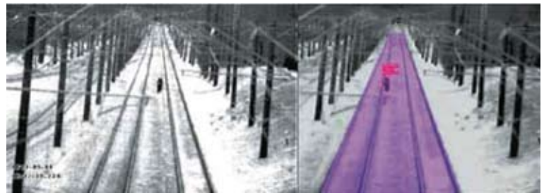
Рис. 3. Пример изображения с тепловизионного модуля «Астрон-3А». Условия: ночь, отсутствие освещения и легкий снег. Изображение «позитивное». Дальность до человека – 400 м. Дальность зоны наблюдения (выделено красным) – 1100 м
