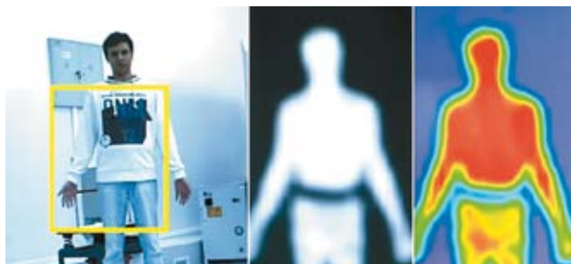
Рис. 6. Изображения тест-объектов в видимом диапазоне (а), в терагерцовом диапазоне (б) и суммарное обработанное изображение (в)
